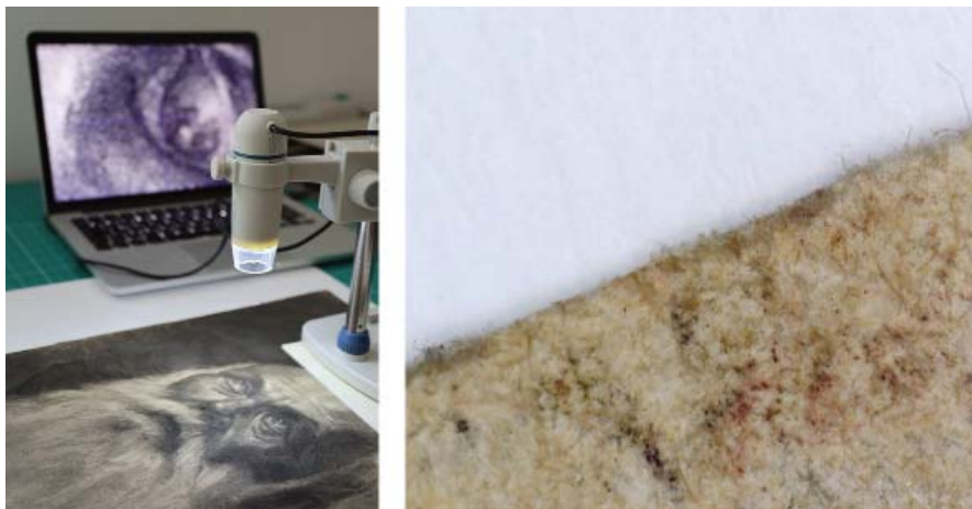
Il. 8. Obserwacja obiektu z użyciem mikroskopu cyfrowego. W powiększeniu widoczne włókna papieru, fot. S. Popławska
