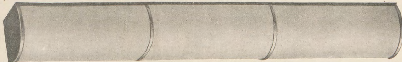
3822 Szkla w kształcie \frac{1}{4} cylindra, dług. 50 cm. i promieniu 15 cm. 4-5 żarówek na metr bieżący pasa.
