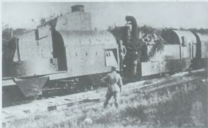
Czołowy wagon artyleryjski i lokomotywa opancerzona serii 377.
