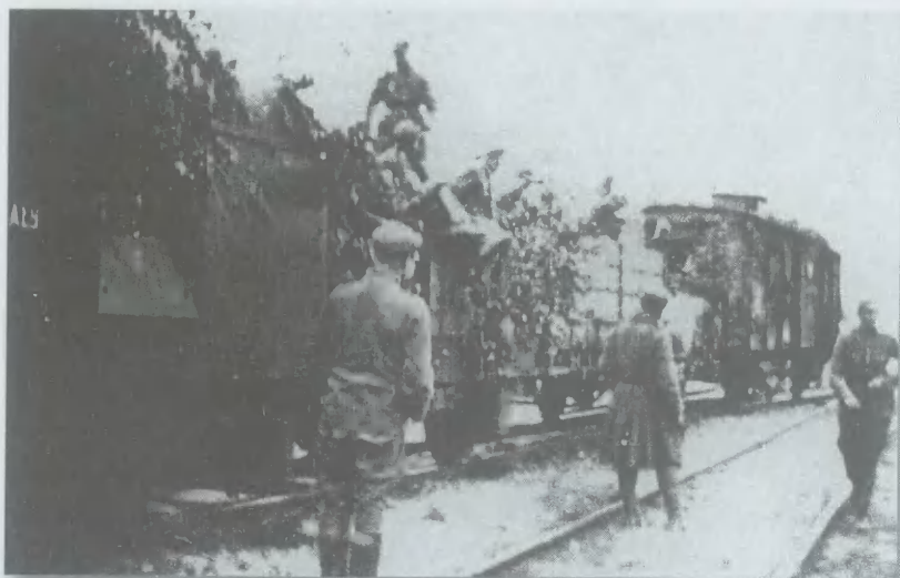
„Śmiały” na postoju, dobrze widoczny fragment wagonu szturmowego, improvizowany wagon armatni z działem 9 cm i na końcu wagon opancerzony betonem dla żołnierzy, lato 1919 r. (ze zbioru K. Margasińskiego).
