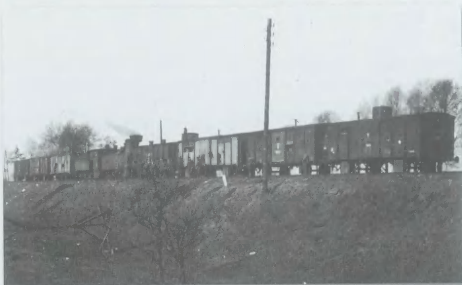
Improwizowany pociąg pancerny PP-7 „Smok”, z improwizowanymi wagonami opancerzowanymi betonem działał również w rejonie Lwowa i na linii do Przemyśla (ze zbioru K. Margasińskiego).
