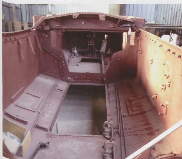
olejne etapy konserwacji kadłuba czołgu. Zdjęcie górne: po demontażu pancerza widoczny przedział napędowy. Zdjęcie środkowe: kadłub przygotowany do piaskowania. Zdjęcie dolne: kadłub po piaskowaniu zabezpieczeniu przed korozją
