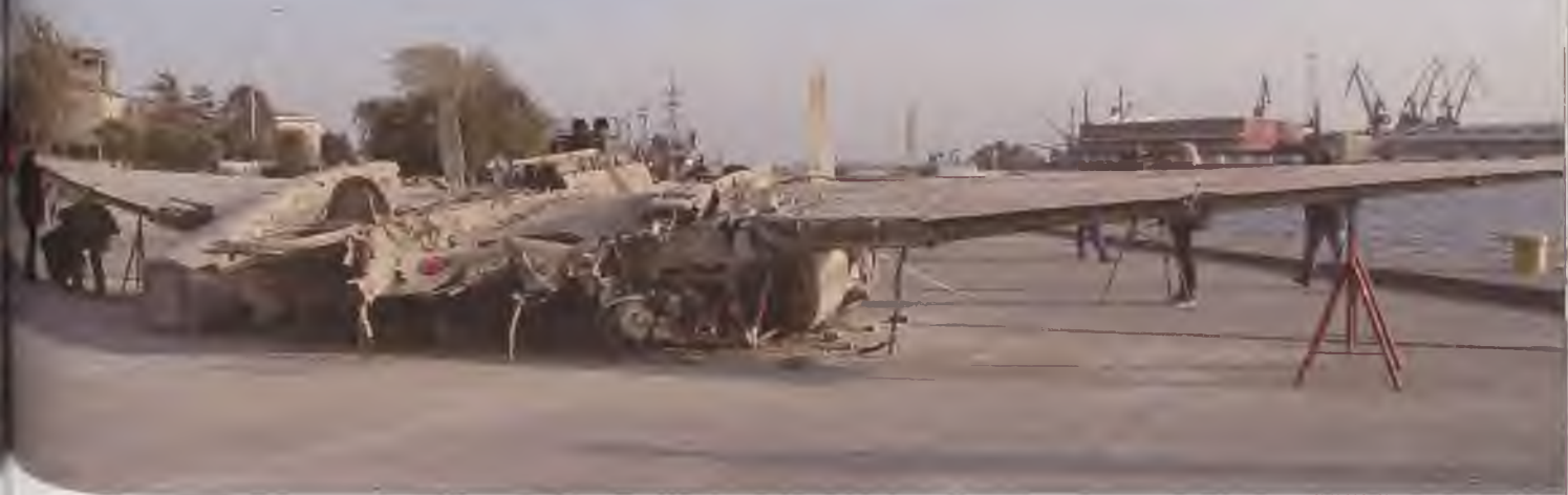
Prawa ostona silnika i podwozia została uszkodzona między pierwszą a drugą próbą wydobywania
