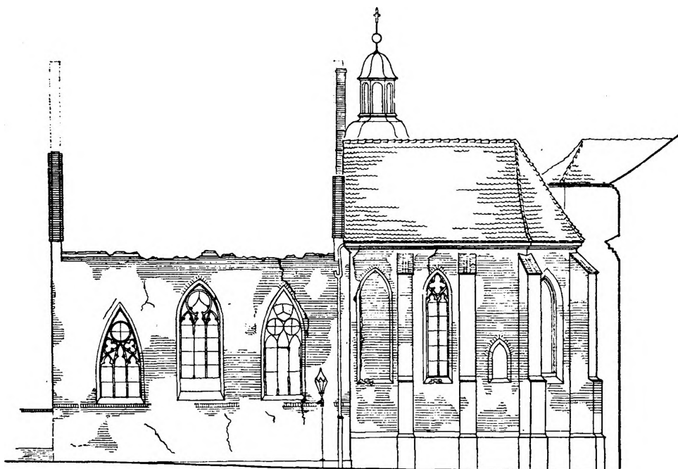
Ryc. 248. Elewacja południowa — inwentaryzacja stanu zniszczeń (skala ok. 1:250).
