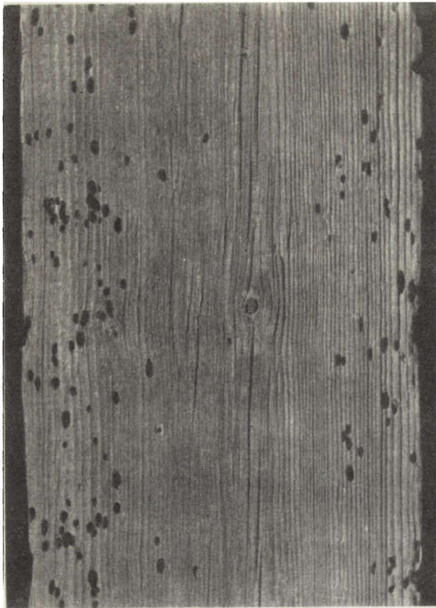
5. Drewno porażone przez owady spuszczała — Hylotrupes bajulus . Widoczne owalne otwory wylotowe (fot. S. Kinelski)
