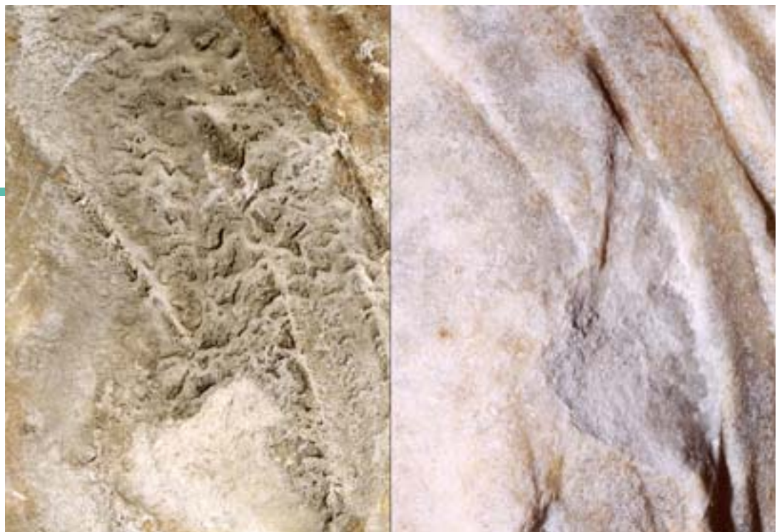
5. Powierzchnia marmuru z naciekowym nawarstwieniem krzemianowo-kalcytowym przed i po oczyszczeniu urządzeniem ReNOVALaser 3.
