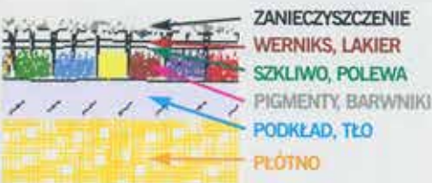
▲ Ilustracja nawarstwień obcych, werniksu i warstw malarskich – przekrój.
