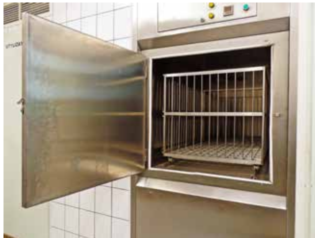
Biblioteka Narodowa, Instytut Konserwacji Zbiorów Bibliotecznych – wnętrze komory przewietrzania, fot. Jakub Piechal
