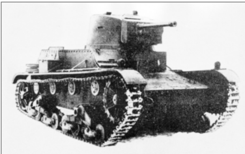
Jednowieżowy czołg 7TP z wieżą Boforsa i działkiem 37 mm. Był to najwartościowszy czołg przedwrześniowej broni pancerniej w Polsce.
