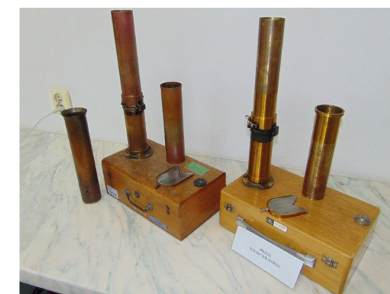
Gęstościomierze zbożowe wzorcowe 1 L oraz 1/4 L
