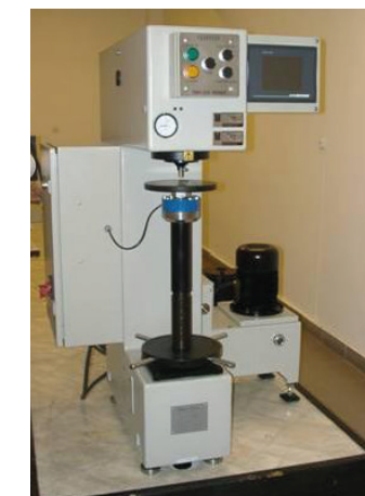
Stanowiska wzorca odniesienia twardości Brinella wraz z mikroskopem
