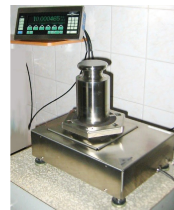
Stanowiska pomiarowe do przekazywania jednostki masy od 50 kg do 500 kg i 1000 kg w klasie F_2
