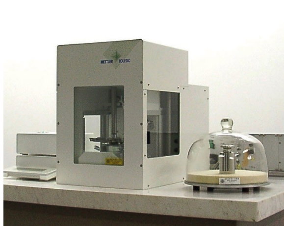
Stanowisko do utrzymywania i przekazywania jednostki miary masy 1 kg od wzorca państwowego
