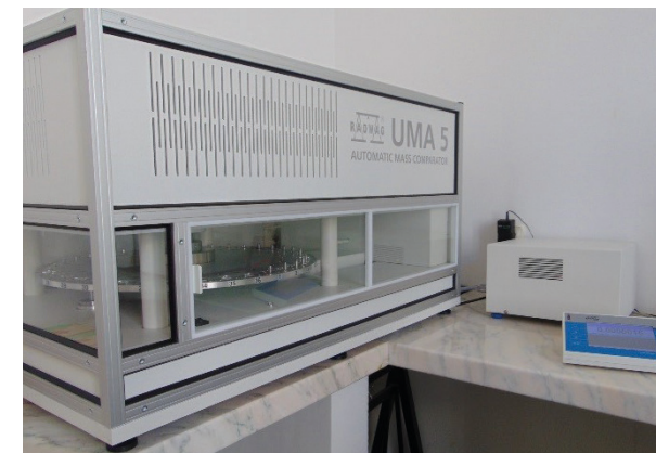
Stanowisko do przekazywania jednostki masy od 5 g do 1 mg
