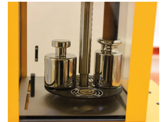
Stanowisko do przekazywania jednostki masy od 1 kg do 100 g
