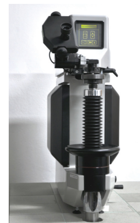
Stanowiska wzorca odniesienia twardości Brinella wraz z mikroskopem
