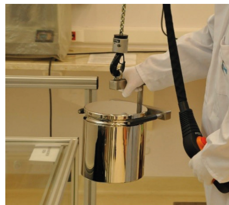
Stanowisko do przekazywania jednostki masy od 20 kg do 50 kg
