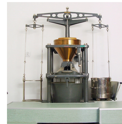
Państwowy wzorcowy gęstościomierz zbożowy 20 L oznaczony numerem 111
