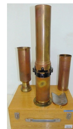
Gęstościomierze zbożowe wzorcowe 1 L oraz 1/4 L
