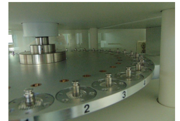
Stanowisko do przekazywania jednostki masy od 5 g do 1 mg
