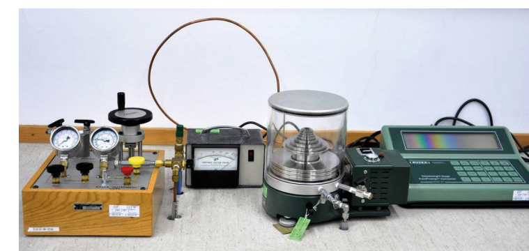
Ciśnieniomierz obciążnikowo-tłokowy wraz z panelem sterowniczym i próżniomierzem
