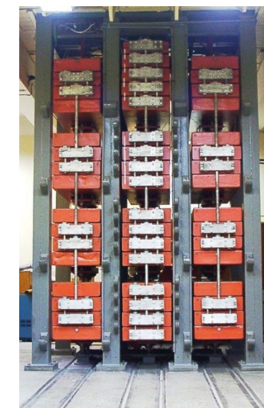
Obciążenie żeliwne o masie ponad 50 ton do stanowiska wzorcowego siły do 500 kN
