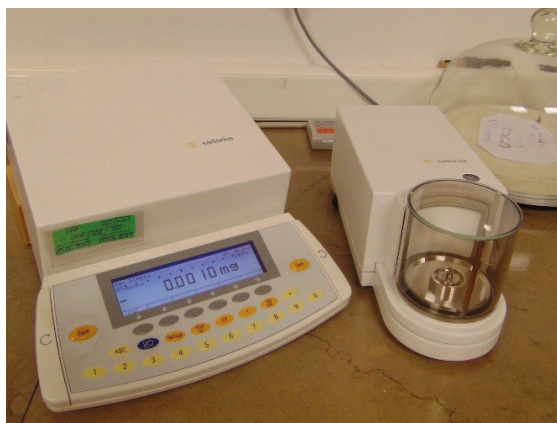
Stanowisko do przekazywania jednostki masy od 1 g do 1 mg
