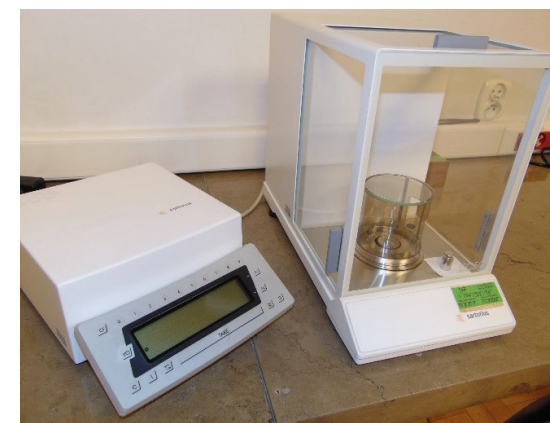
Stanowiska do przekazywania jednostki masy od 200 g do 1 g
