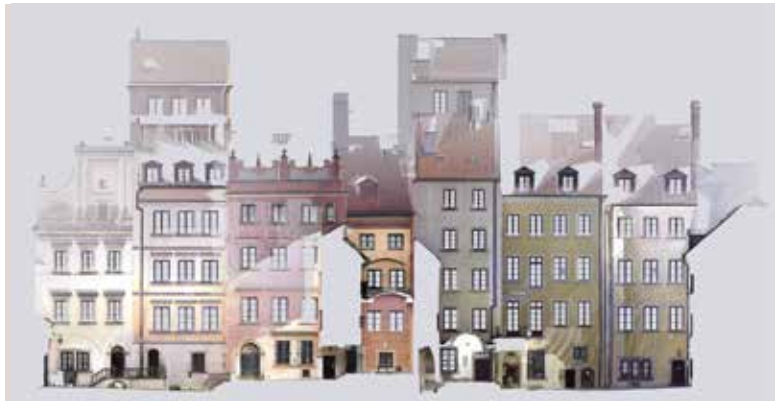
Skan elewacji zachodniej, rysunek i ortofotomapa
