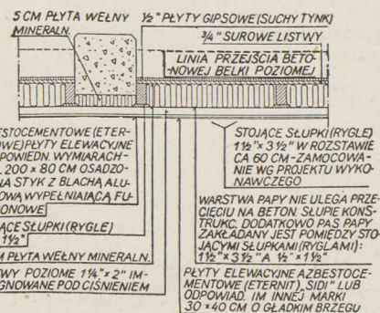
Przekrój konstrukcyjny ściany budynku 11-kondygnacyjnego (do fotografii poniżej)
