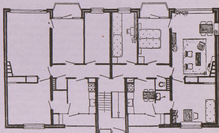
1. Rzuty budynków wieloizbowych o poprzecznym układzie w Duitland w Holandii. Dwie rozpiętości stropów. Natryski w połączeniu z umywalkami, dostępne z kuchni i pokoju sypialnego. Wentylacja skoncentrowana w jednym punkcie. Autorzy architekci I. C. Rentjes i B. Koning
