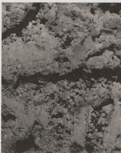
3. Przykłady wykorzystania zdalnie sterowanego przyrządu: A – linia i płaszczyzna wykonane pistoletem natryskowym, B – linia i płaszczyzna wykonane tamponem, C – powłoka woskowa, D – kruszywo z barwnego tworzywa sztucznego rzucone na spoiwo bitumiczne przez głowicę, E – relief wykonany sprężonym powietrzem w świeżej zaprawie wapienno-gipsowej przy pomocy końcówki przewodu ciśnieniowego
