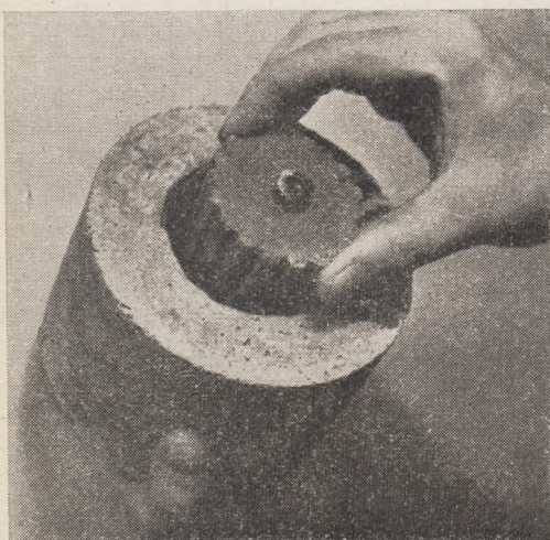
4. Zakotwienie stożkowe do kabli 12 \phi 5
