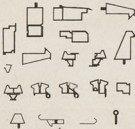
Profile z polichlorku winylu „Uniplast” (wyrób włoski), pozwalające na wykonanie różnych rodzajów ram okien i drzwi szklonych
