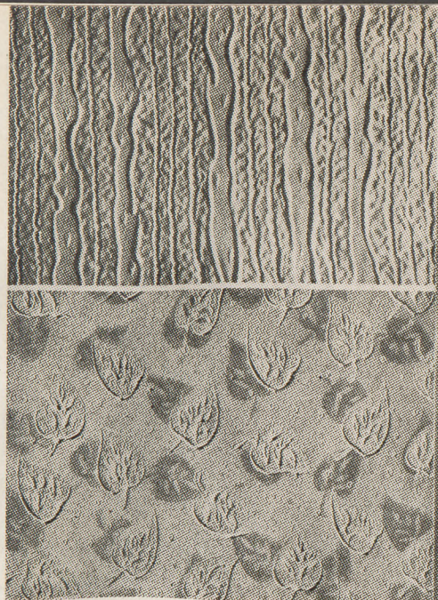
Reliefowe powłoki ścienna z masy produkowanej przy użyciu poliocetanu winylu
