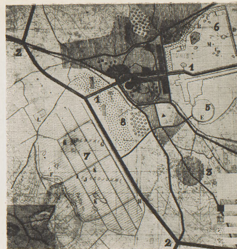
2. Tunis. Schemat 1:10000. Objaśnienia: 1—1 — oś śródmiejska, 2—2 — arteria tranzytowa, 3 — proj. osiedle satelitarne, 4 — centrum rządowe, 5 — port, 6 — pogłębiona część Lac de Tunis, 7 — teren upraw rolnych es Sedjoui, 8 — osuszone tereny (sport). Partie zaczerpnięte oznaczają główne koncentracje usług
