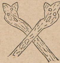
Ryc. 12. Śparogi „krzyżownica“ z wyciętymi otworami
